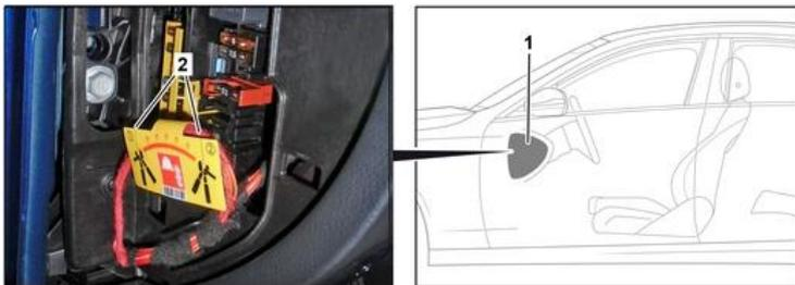
取掉盖板 (1)。在标记点 (2) 处切断电线。
