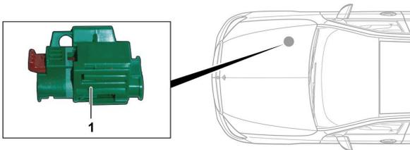
高压断开装置位于 副驾驶侧的发动机舱内。
