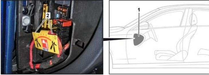
取掉盖板 (1)。在标记点 (2) 处切断电线。
