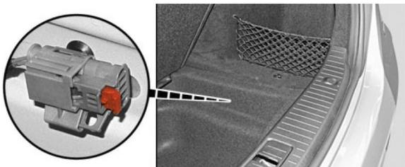
高压断路装置位于右后行李箱槽盖板下方。通过车辆中心承载梁下方的拉片将槽饰板从行李箱中拔出。
