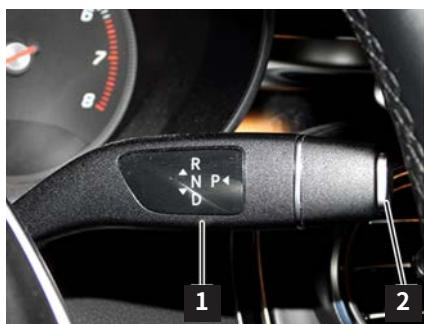
1 方向盘上的自动变速器选挡杆
