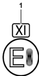
1 Contrassegno per vetro di sicurezza stratificato (esempio)
