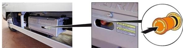
Gumb za izklop v sili je v vdolbini bočne oblage visokonapetostnega akumulatorja.
