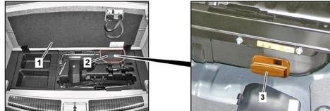
Поднять пол багажного отделения (1) / удалить крышку (2) / сдвинуть выключатель (3) вправо и отсоединить от высоковольтной бортовой сети
