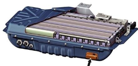
Устройство отключения высоковольтной бортовой сети находится сзади справа по направлению движения рядом с высоковольтной аккумуляторной батареей.
