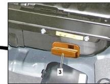
Устройство отключения высоковольтной бортовой сети находится сзади справа по направлению движения рядом с высоковольтной аккумуляторной батареей.
