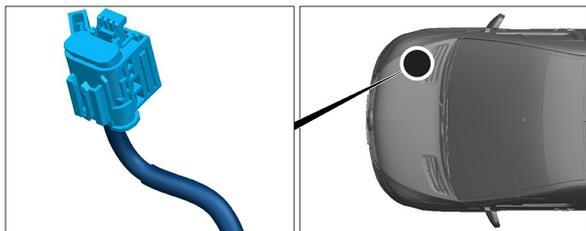
Устройство отключения высокого напряжения находится в моторном отсеке справа по направлению движения.
