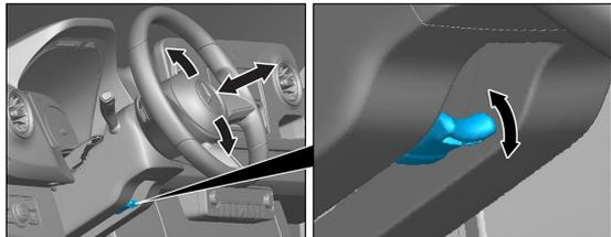
Регулировка рулевого колеса
