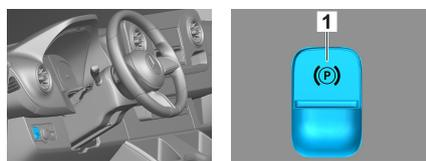
Нажмите переключатель P на рычаге селектора (1). Парковочный тормоз (электрический) включается автоматически.
