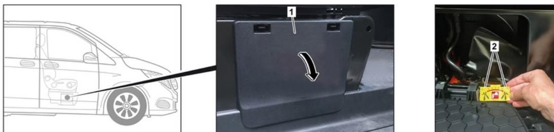
Снимите крышку (1). Отрежьте провод в отмеченном месте (2).
