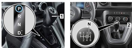
1. Установите рычаг селектора в положение P.
