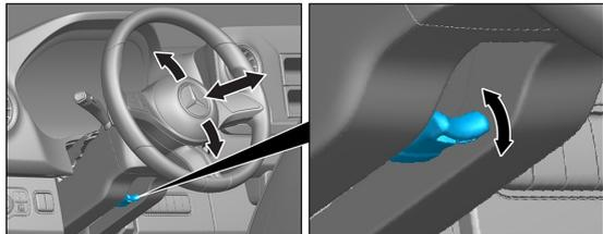
Регулировка рулевого колеса
