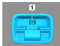
Нажмите переключатель P на рычаге селектора (1). Парковочный тормоз (электрический) включается автоматически.
