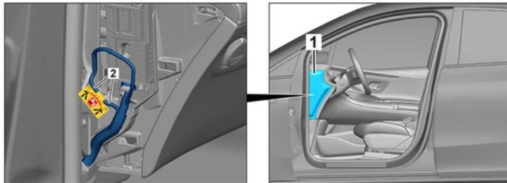
Снимите крышку (1). Отрежьте провод в отмеченном месте (2).
