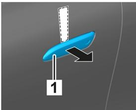
Вставьте плоский неметаллический предмет сверху за убранный дверную ручку (1) и слегка подтолкните ее наружу.
