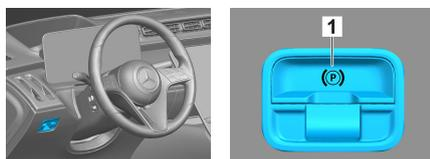
Нажмите переключатель P на рычаге селектора (1). Парковочный тормоз (электрический) включается автоматически.
