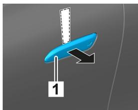
Вставьте плоский неметаллический предмет сверху за убранныю дверную ручку (1) и слегка подтолкните ее наружу.
