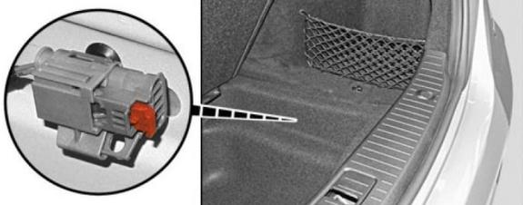
Под крышкой ниши сзади справа в багажнике находится устройство отключения высоковольтной бортовой сети. Облицовка ниши из багажника вытягивается за петлю под краем погрузочного пространства по центру автомобиля.
