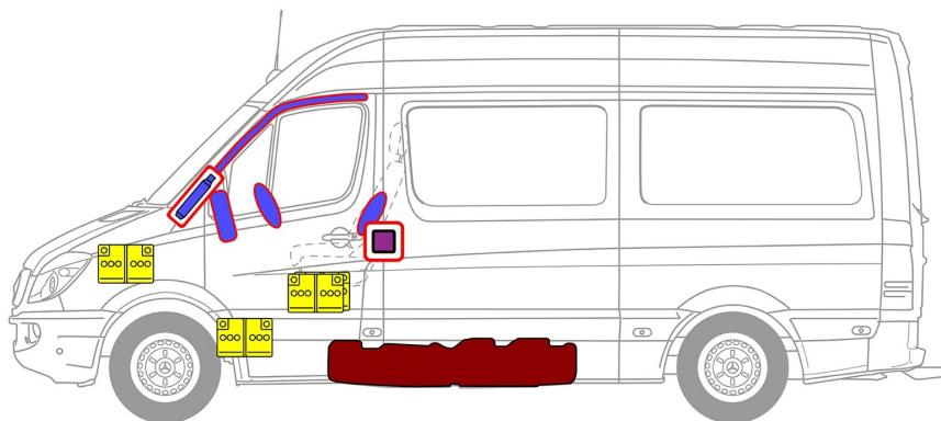
① Стартерная аккумуляторная батарея (Автомобиль с левым расположением рулевого управления / Автомобиль с правым расположением рулевого управления)
