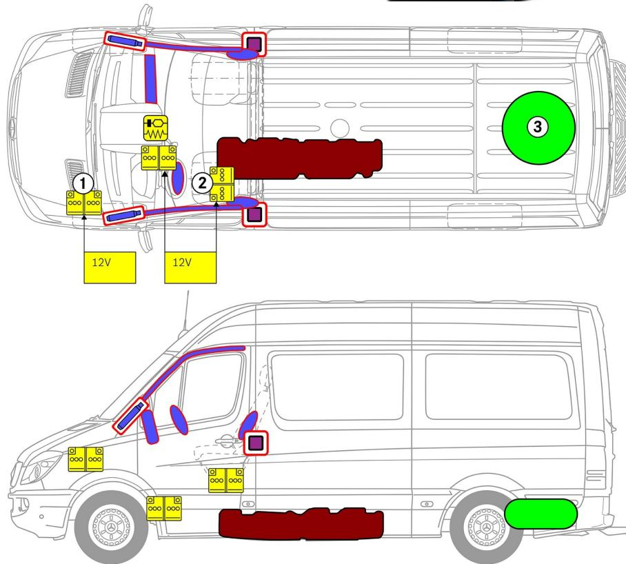
① Дополнительная аккумуляторная батарея (а/м с левым расположением рулевого управления)
