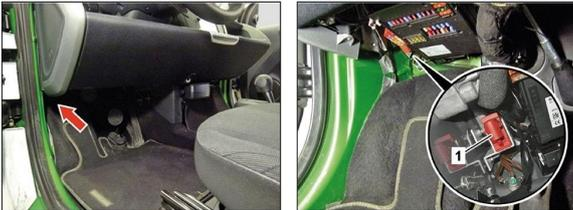
O dispositivo de corte de alta voltagem encontra-se na parte inferior do painel de instrumentos no sentido da marcha à esquerda.
