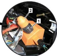
O dispositivo de corte de alta voltagem encontra-se em cima no compressor do líquido do ar condicionado (3) no compartimento do motor no sentido da marcha à esquerda.
