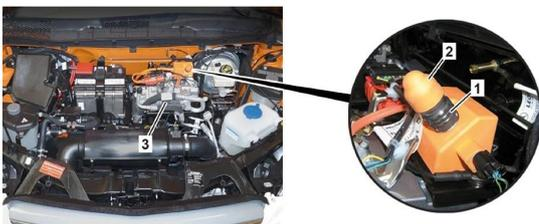
O dispositivo de corte de alta voltagem encontra-se em cima no compressor do líquido do ar condicionado (3) no compartimento do motor no sentido da marcha à esquerda.
