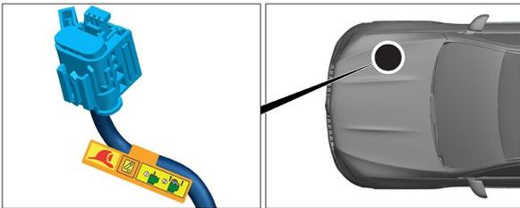
O dispositivo de desconexão de alta voltagem encontra-se no compartimento do motor no lado do acompanhante.
