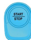
A ausência de sons do motor não significa que o veículo esteja desligado.
