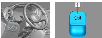
Premir a alavanca de seleção (1) na posição P. O travão de estacionamento é ativado automaticamente.
