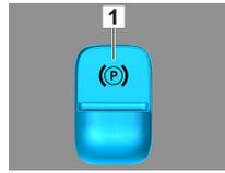
Premir a alavanca de seleção (1) na posição P. O travão de estacionamento é ativado automaticamente.
