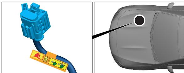
O dispositivo de desconexão de alta voltagem encontra-se no compartimento do motor na direção de marcha à direita.
