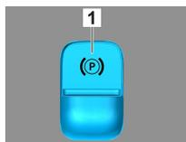
Premir a alavanca de seleção (1) na posição P. O travão de estacionamento é ativado automaticamente. Travão de estacionamento elétrico (1)
