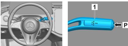
Pressionar o interruptor P na alavanca de seleção (1). O travão de estacionamento é ativado automaticamente.
