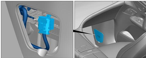
O dispositivo de desconexão de alta voltagem está localizado na parte inferior do pilar A do lado do acompanhante.
