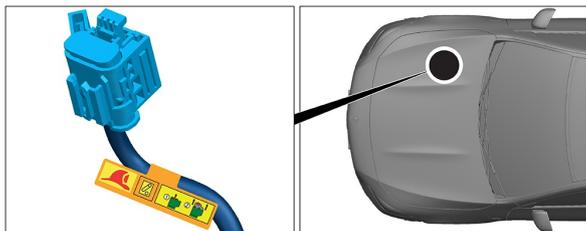
O dispositivo de desconexão de alta voltagem encontra-se no compartimento do motor no lado do acompanhante.
