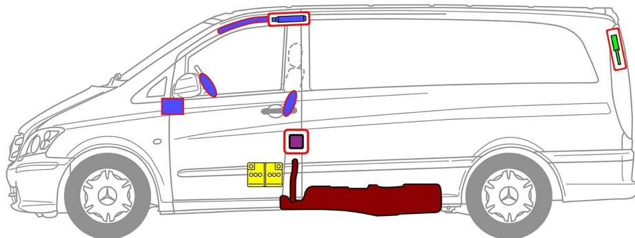
① Bateria do motor de arranque (Veículo com volante à esquerda) / Bateria suplementar (Veículo com volante à direita)
