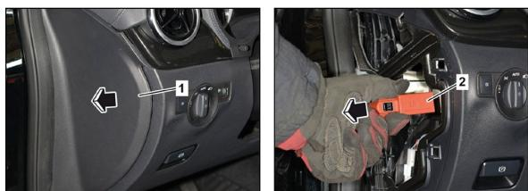
O dispositivo que corta a alta voltagem encontra-se atrás do revestimento lateral do painel de instrumentos, à esquerda, no sentido da marcha.
