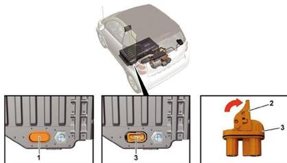
O dispositivo de corte de alta voltagem encontra-se na parte inferior da bateria de alta voltagem no sentido da marcha atrás à esquerda.
