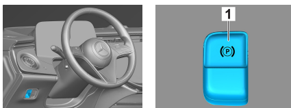
Travão de estacionamento elétrico (1)
