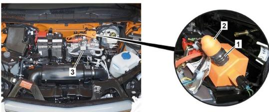
O dispositivo de desligamento de alta voltagem encontra-se em cima no compressor do agente refrigerante (3) no compartimento do motor no sentido da marcha à esquerda.
