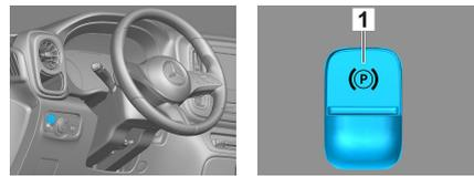
Pressionar a alavanca seletora (1) na posição P. O freio de estacionamento é ativado automaticamente.
