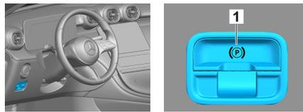
Pressionar o interruptor P na alavanca seletora (1).
