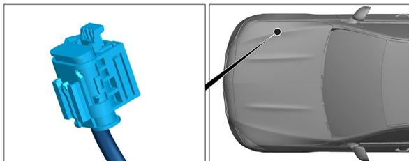
O dispositivo de desconexão de alta voltagem encontra-se no compartimento do motor na direção de marcha à direita.
