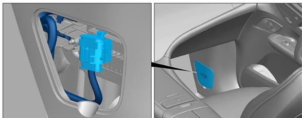
O dispositivo de desligamento de alta voltagem se encontra embaixo, na coluna A, no lado do acompanhante.
