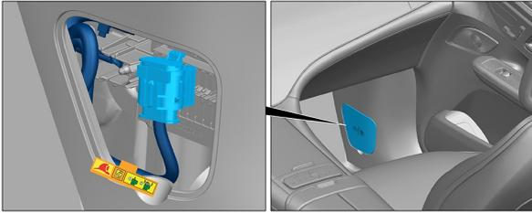
O dispositivo de desligamento de alta voltagem se encontra embaixo, na coluna A, no lado do acompanhante.
