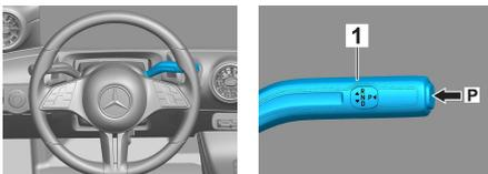
Pressionar o interruptor P na alavanca seletora (1).
