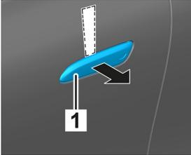
Empurrar um objeto plano não metálico por cima, atrás da maçaneta da porta (1) retraída e alavancar levemente para fora.
