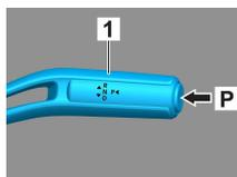
Pressionar o interruptor P na alavanca seletora (1).
