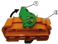
O dispositivo de desligamento de alta voltagem se encontra no lado inferior da bateria de alta voltagem no sentido de deslocamento direito traseiro.
