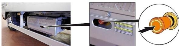
O botão de desligamento de emergência se encontra no entalhe do revestimento lateral da bateria de alta voltagem.
