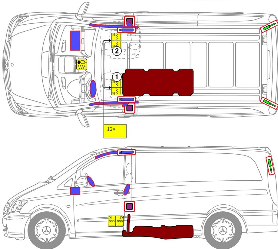
① Bateria de partida (direção à esquerda) ou bateria adicional (direção à direita)
