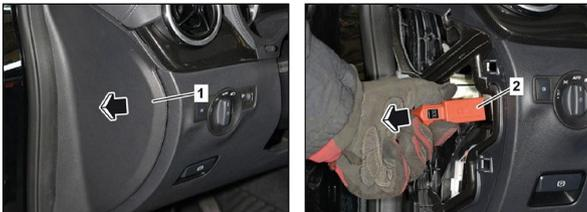
O dispositivo de desligamento de alta voltagem se encontra no sentido de deslocamento esquerdo atrás do revestimento lateral do painel de instrumentos.
