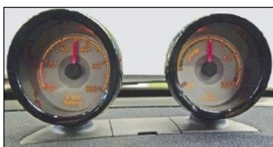
⑤ Exibição do estado de carga/fluxo de energia da bateria de alta tensão
