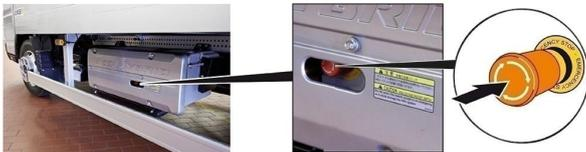
緊急停止ボタンは、高電圧バッテリーのサイド・トリムのリセスにあります。
