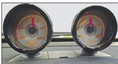
⑤ Индикация степени заряда / энергопотока высоковольтной аккумуляторной батареи
