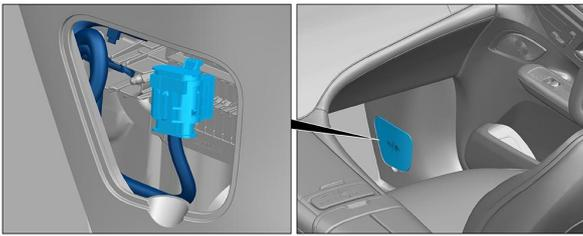
Die Hochvolt-Abschaltvorrichtung befindet sich unten in der A-Säule auf der Beifahrerseite.
