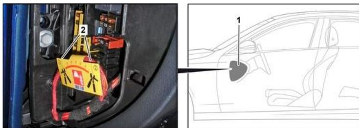
Снимите крышку (1). Отрежьте провод в отмеченном месте (2).
