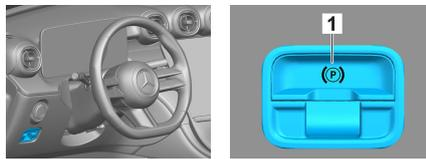
Appuyer sur le bouton P sur le levier de vitesses (1). Le frein de parking est automatiquement activé. Frein de stationnement électrique (1)
