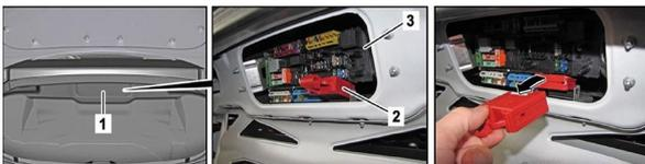
Debajo de la tapa cobertera de la caja de fusibles y relés en la pared posterior del maletero se encuentra el dispositivo de desconexión de alto voltaje.
